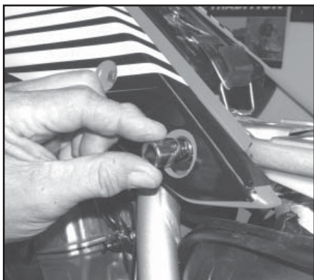
4. Remove the front sub-frame bolt.
